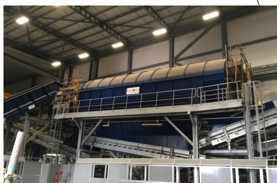
(1) VAGLIO MECCANICO PER SELEZIONARE LE DIVERSE MATRICI
